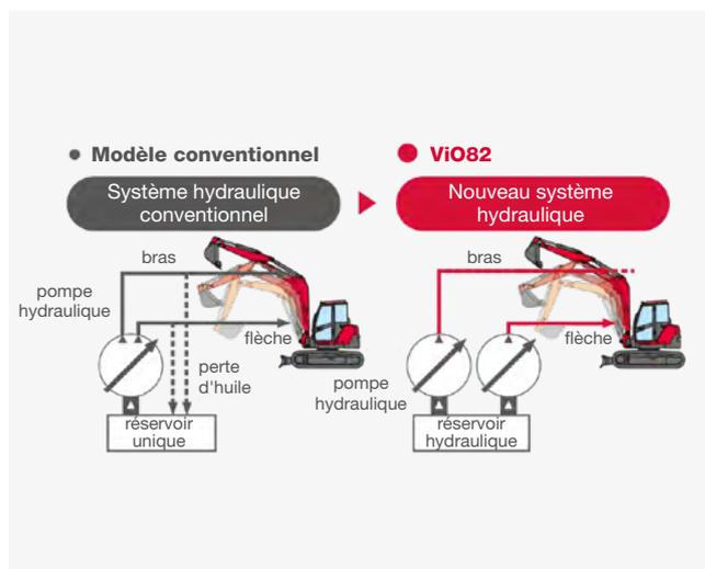
Fournit toujours la quantité maximale de fluide possible, ce qui signifie que le fluide superflu est renvoyé dans le réservoir.
