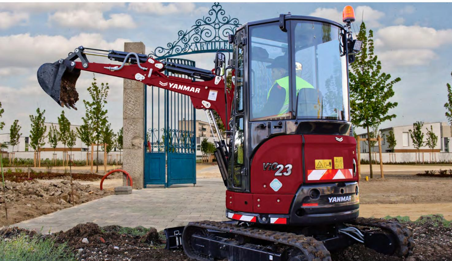
La ViO23-6 offre des performances exceptionnelles pour un engin de sa catégorie. Sa profondeur de fouille de 2450/2655 mm\* et ses forces de fouille de 17,5 kN (godet) et 13,1/10,6 kN\* lui permettent de travailler rapidement et efficacement même dans les conditions les plus difficiles.
