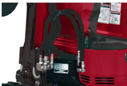
2 Tubes et flexibles hydrauliques parfaitement protégés.
