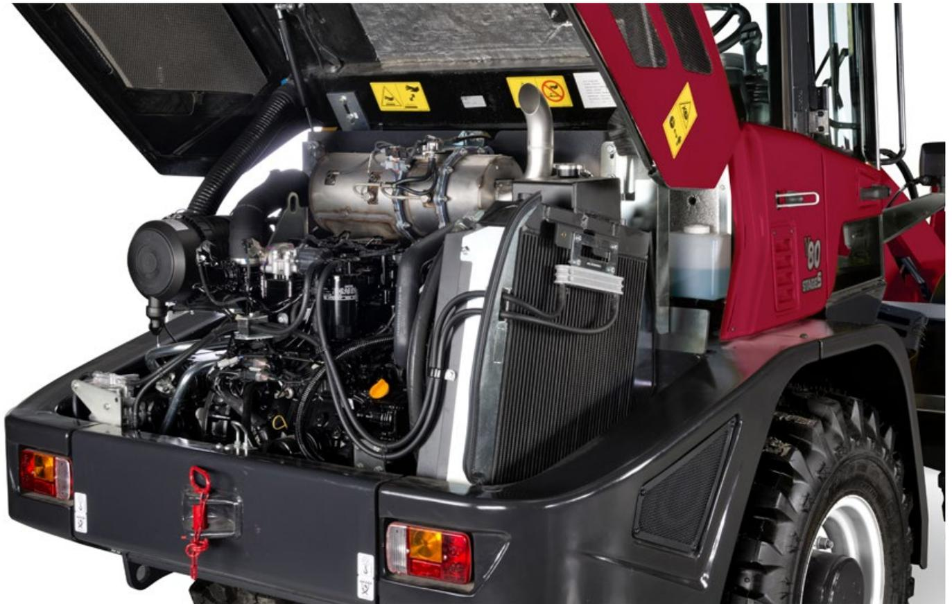
La grande ouverture offerte par le capot moteur permet d'accéder facilement à l'ensemble des principaux points de service, pour une maintenance facile et rapide. Ceci contribue à réduire le coût total de possession de la machine. Les tâches quotidiennes peuvent être réalisées depuis le sol pour gagner du temps.
