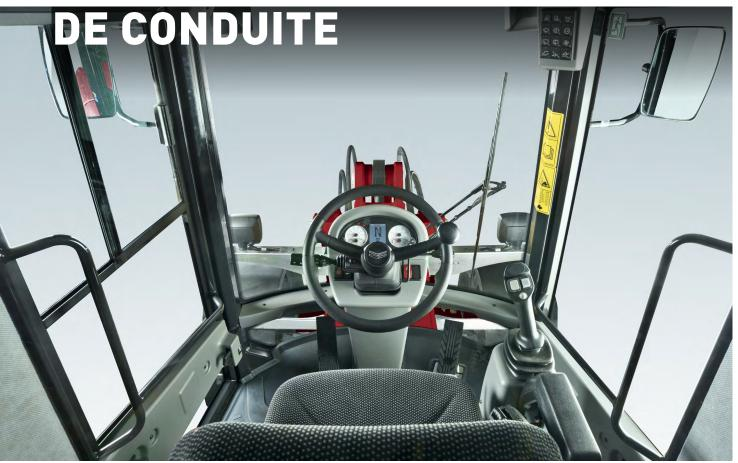
Conçue dans un souci de confort de l'opérateur et de productivité, la cabine présente un amortissement du bruit et des vibrations et est homologuée ROPS/FOPS.
