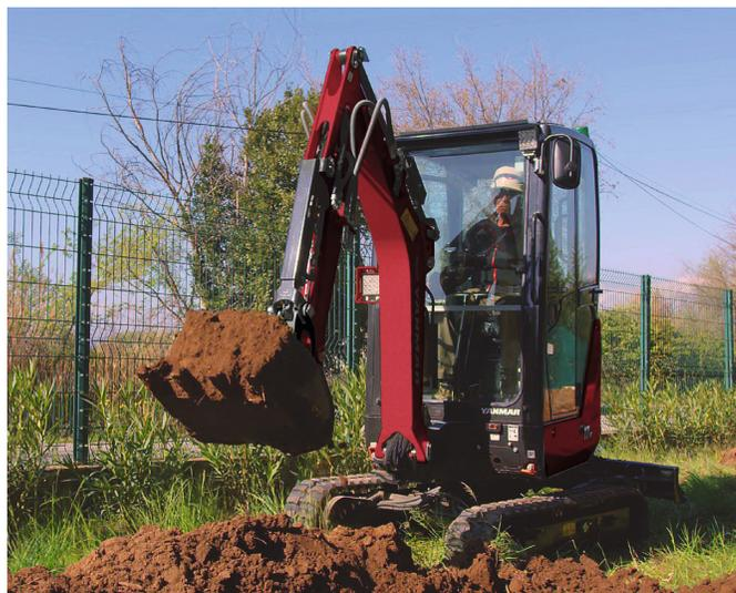
Avec une force d'excavation de 9,9/16 kN (bras court/godet), une force de traction de 12,8 kN/8 kN (première/deuxième vitesse) et deux vitesses de translation (2,4 ou 4,8 km/h) contrôlées via le levier de commande de la lame, la SV17vr offre la puissance et les performances d'un modèle beaucoup plus grand.
