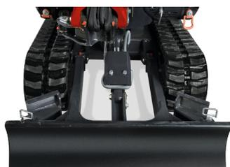
Châssis rétracté : 980 mm
