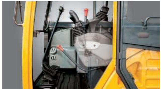
La console gauche peut s'incliner, offrant ainsi à l'opérateur un accès plus aisé à la cabine. Le système de verrouillage de sécurité vise à empêcher toute sortie de la cabine tant que le R18-9 est en cours de marche. Dès que le levier de sécurité et la console gauche sont positionnés à la verticale, les fonctions hydrauliques se désactivent.
