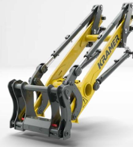
La cinématique P convainc dans la pratique grâce à sa force d'arrachement importante, à sa grande force de maintien en hauteur des charges dans la partie supérieure du dispositif, et à sa précision exemplaire dans le travail avec des charges lourdes. La conception ouverte du bras chargeur assure une visibilité optimale sur l'équipement. Cet avantage est particulièrement manifeste lors de travaux de chargement et de déchargement ou de gerbage à des hauteurs de levage élevées.
