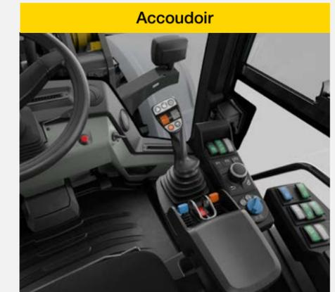
L'accoudoir, qui comprend la console joystick et le Jog Dial, est monté sur le siège conducteur et accueille tous les éléments de commande importants. Cela permet d'avoir toujours la main gauche sur le volant, et la main droite sur l'accoudoir. L'accoudoir peut être rabattu, ce qui permet d'accéder à la cabine par le côté droit.
