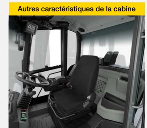
Le design de la cabine protège le conducteur des émissions sonores (70 dB(A)). En outre, la climatisation automatique, les phares de travail et l'essuie-glace arrière peuvent être contrôlés sur le côté, au-dessus de l'écran 7 pouces. D'autres caractéristiques de la cabine : radio Bluetooth avec dispositif mains-libres, prise 12 V avec trappe de protection, deux ports USB et plus encore.
