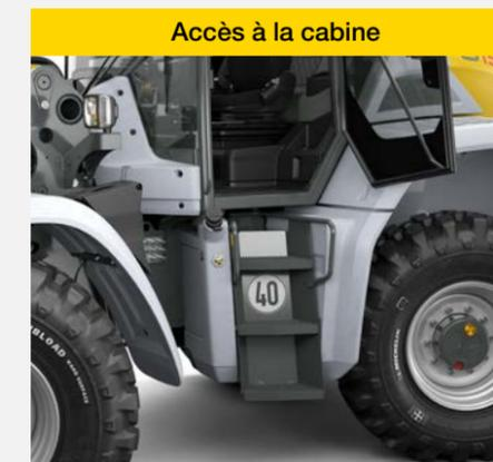
Il est possible de monter dans la cabine conducteur depuis les deux larges zones de montée situées de chaque côté et composées de trois marches. Quatre mains courantes (une à gauche sur le montant A, deux près des marches et une sur la porte) permettent une montée et une descente de la machine des deux côtés en toute sécurité. La cabine dispose également d'un éclairage intérieur avec interrupteur à contact de porte.
