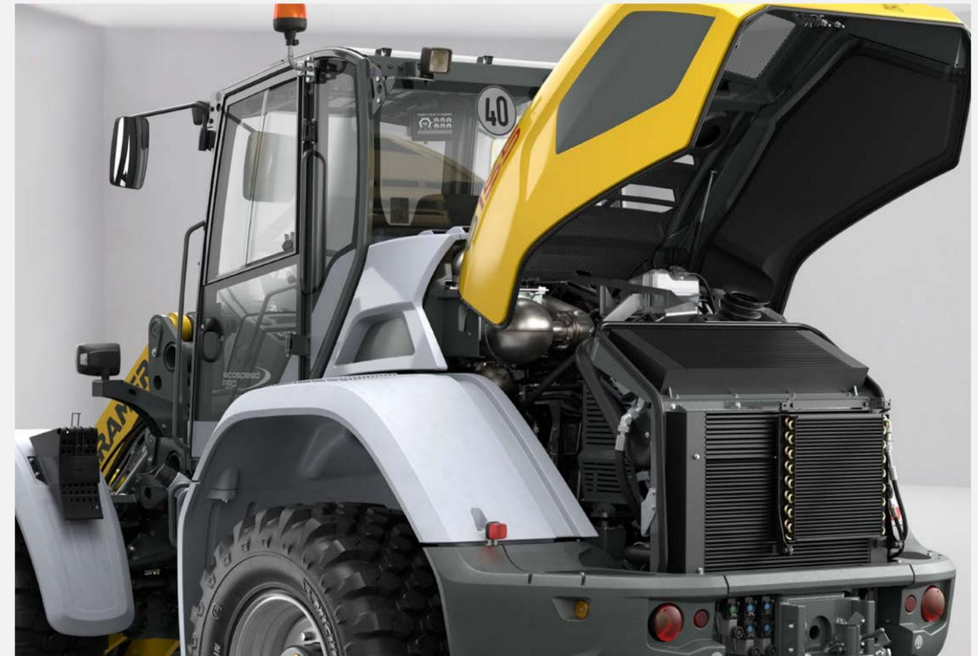
Moteur 4 cylindres en ligne à refroidissement liquide avec recirculation externe refroidie des gaz d'échappement, turbocompresseur et refroidissement de l'air de suralimentation.
