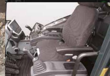
La HX220AL dispose d'un **siège luxueux à suspension pneumatique avec chauffage** de série. Les **manettes ergonomiques** rendent l'utilisation confortable et intuitive.
