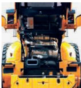
Le **capot moteur basculant vers l'arrière est entièrement rétractable** et peut être **ouvert électriquement** pour faciliter l'accès au compartiment moteur étanche et à la chambre de refroidissement. Le compartiment moteur est conçu de sorte à éviter tout risque de feu causé par l'entrée de corps étrangers.
