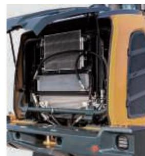
La HL955A dispose d'un **radiateur d'air à large noyau et à ailettes** fiable qui empêche la réduction des performances causée par la contamination.
