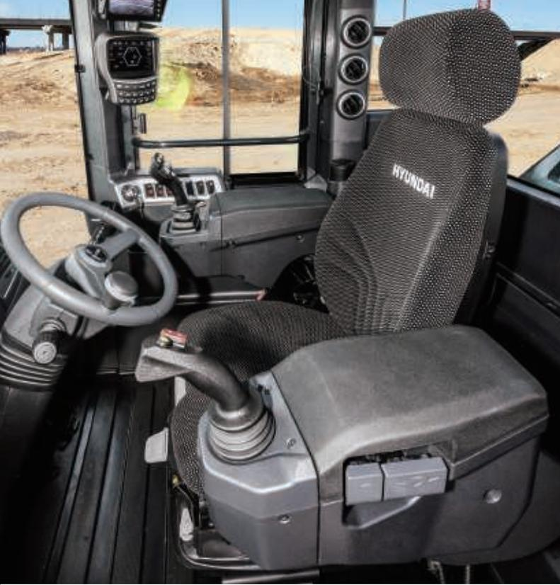
La HL955A possède un **siège avec accoudoir large et entièrement réglable** conçu pour aider les opérateurs à travailler plus longtemps et de manière plus productive. Pour plus de confort, un siège à suspension pneumatique est disponible en option.
