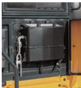
Le **filtre de la climatisation** est facile à remplacer.
